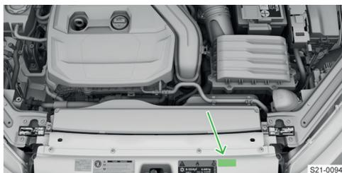
При необходимости пополнить уровень моторного масла следует использовать масло, указанное на наклейке в моторном отсеке.
