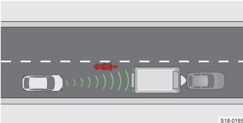
Адаптивный круиз-контроль (ACC) распознаёт узкое транспортное средство или транспортное средство, движущееся со сдвигом, только когда оно попадёт в область контроля радарного датчика.
