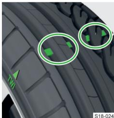
На основании протектора шин имеются индикаторы износа, которые показывают минимально допустимую высоту рисунка протектора.
