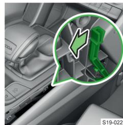
► Потяните за пластиковую деталь в направлении стрелки и одновременно нажмите кнопку на рычаге селектора.
