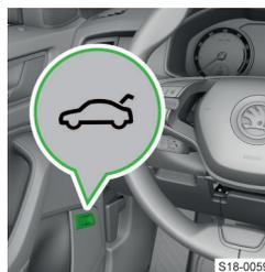
1. Чтобы открыть крышку багажного отсека, потяните кнопку и удерживайте, пока крышка багажного отсека не начнёт открываться.
